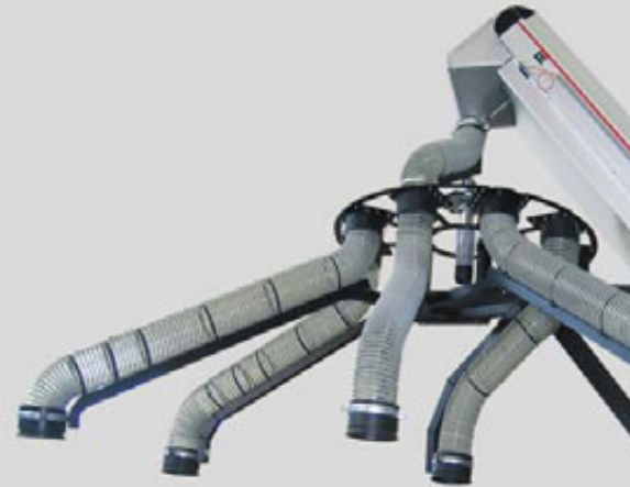
Specialsystem til automatisk transport og fordeling af drikkeflaskekapsler i flere beholdere.
