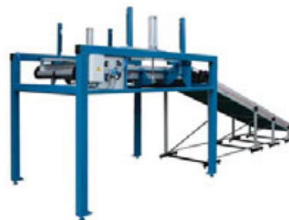
Båndkombination med pneumatisk tippeanordning til påfyldning af store beholdere
